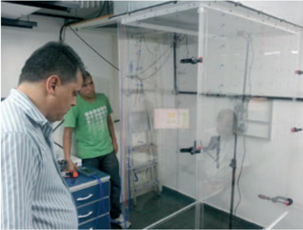
Dispositivo de ensaio montado com anemômetro sendo ajustado
