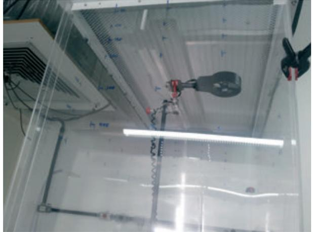
Detalhe da medição feita com anemômetro de Rotor Axial
