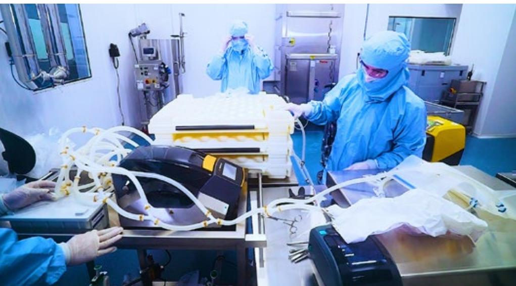
Etapa de envase: dos 4 mil litros iniciais, o processo gera algo em torno de 200 litros de proteína purificada, já na concentração específica para envase final
