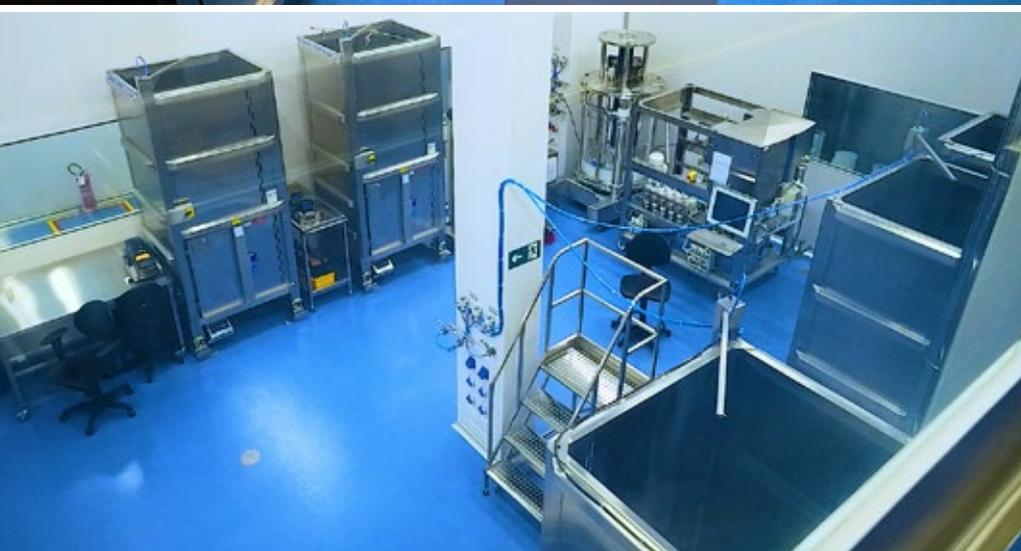
No chamado *downstream* ocorre a etapa de purificação da proteína, que envolve o uso de cromatógrafos
