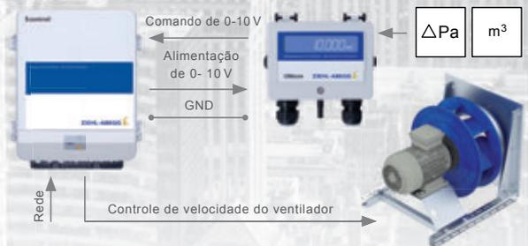
Exemplo de combinação com inversor de frequência Basic lcontrol
