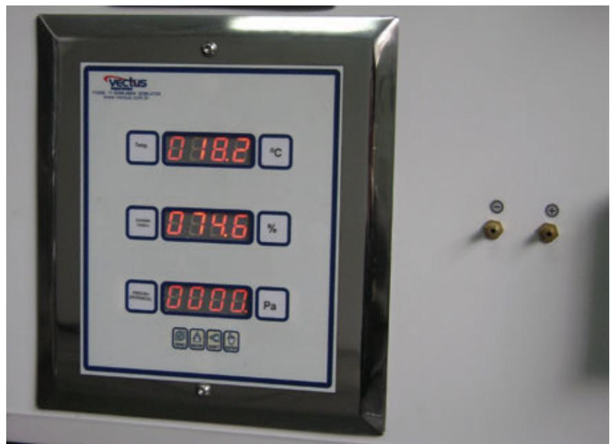
Exemplo de IHM (Interface Homem-Máquina): monitor apresenta condições do ambiente em tempo real para controle dos operadores
