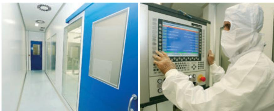
Do corredor ISO classe 8 é possível ter visão total do processo. Operador usa paramentação completa durante todo o processo de produção
