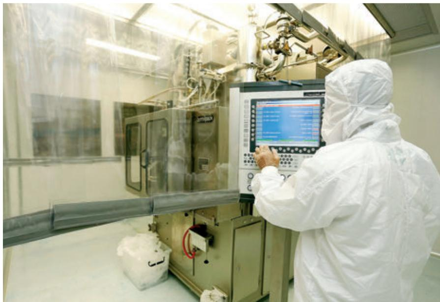
Tanque com capacidade de mil litros realiza a mistura que dá origem ao soro fisiológico, enviado para a máquina via tubulação. Utilizando o painel de controle, operador configura o *set up* da máquina de acordo com a especificação do lote a ser produzido. Todo processo é feito sem qualquer contato direto do operador com o produto
