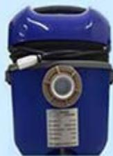
Gerador de fumaça a base de água potável, PW ou WFI para ensaios de visualização de fluxo de ar conforme ISO – 14644-3, Anexo B7.
